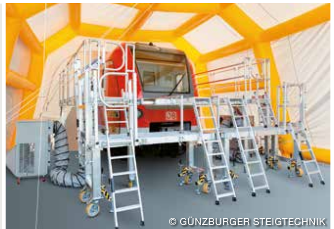
Frontarbeitsbühne im Einsatz bei der DB Fahrzeuginstandhaltung GmbH / Platform for working at the front at DB Fahrzeuginstandhaltung GmbH
