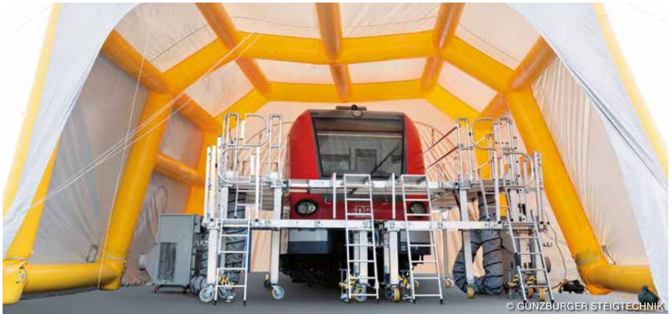
Frontarbeitsbühne im Einsatz bei der DB Fahrzeuginstandhaltung GmbH / Platform for working at the front at DB Fahrzeuginstandhaltung GmbH
