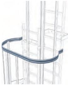
**Rückenschutzbügel für versetzte Ausführung**
