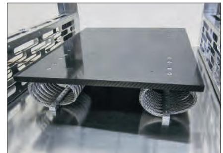
Aufnahmetisch, schwingend gelagert mit Gummipuffer oder Drahtseildämpfer
