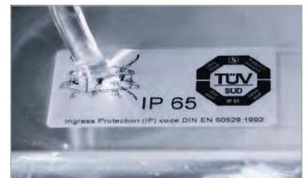
Strahlwasserschutz nach Norm IP 65
