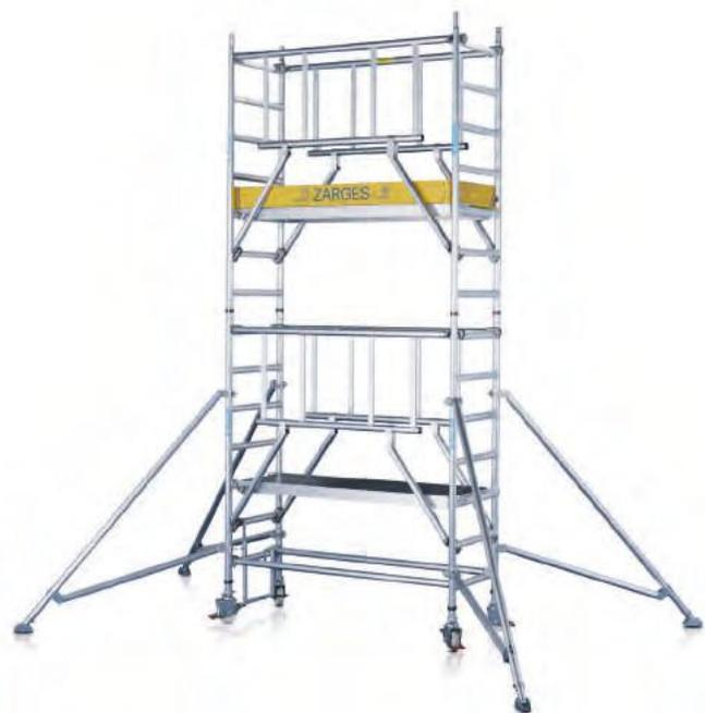
Die fahrbare Gerüstlösung für sicheren und schnellen Aufbau durch vorlaufendes Gelände, zwei Meter Plattformabstand und weniger Einzelteile.
