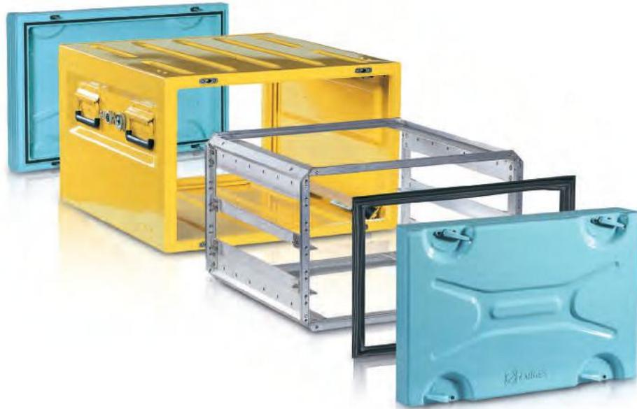
**Mitraset® 19"-Gehäuse aus Aluminium sind für die Aufnahme von Elektronik-Geräten im 19"-Raster gemäß DIN EN 60297-3-100 sowie EIA-310-E konzipiert. Die zu schützenden Elektronikgeräte werden in den elastisch aufgehängten Schwingrahmen eingesetzt und verschraubt und sind so optimal geschützt.**
