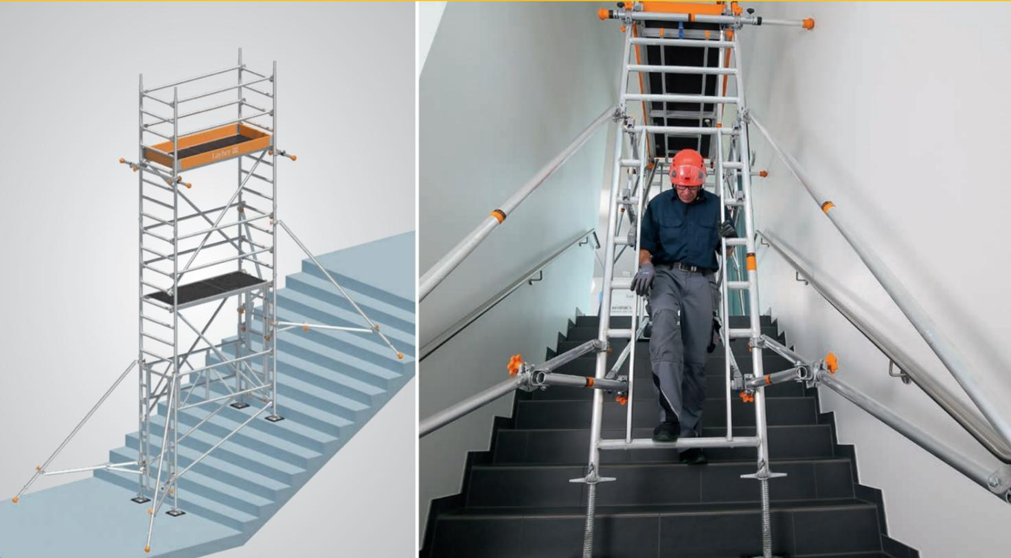
Das Treppen-Kit für das Uni Leicht ermöglicht den sicheren und flexiblen Einsatz von Fahrgerüstteilen in Treppenhäusern: Es bedarf keiner Umbauarbeiten, da die Treppe trotz Gerüst weiter begehbar bleibt.
