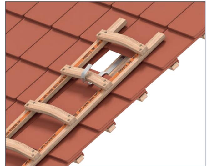
Beispielhafte Anwendung des Sicherheitshakens Modell Z (Pos. 1)
