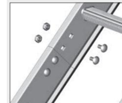
Die Dachleitern werden mit den Verbindungslaschen Art.-Nr. 1049.x03 verbunden. Die Schrauben, Scheiben und Sicherungsmuttern sind im Lieferumfang vorhanden. Es mussen pro Lasche 4 Schrauben verwendet werden. Es konnen bis zu drei Leitern gestoen werden, ohne dass zusatzliche Dachhaken verwendet werden.
