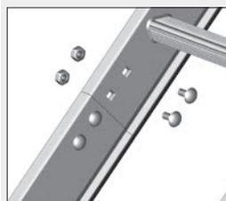
Die Dachauflegeleitern werden mit den Verbindungslaschen Art.-Nr. 1049.x03 verbunden. Die Schrauben, Scheiben und Sicherungsmuttern sind im Lieferumfang enthalten. Es werden 4 Schrauben pro Lasche verwendet. Es sind immer mindestens zwei Dachhaken zu verwenden. Somit können bis zu drei Leitern gestoßen werden, ohne dass zusätzliche Dachhaken verwendet werden müssen.
