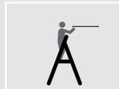
Die Größe von Stehleitern mit Plattform sowie von Podestleitern muss so gewählt werden, dass der Benutzer die maximal erforderliche Arbeitshöhe ohne sich zu recken von der Plattform aus erreichen kann.
