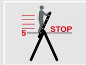
Mehrzweckleitern in der Gebrauchsstellung „Stehleiter mit Steckteil“ dürfen nur bis zur fünftobersten Stufe/Sprosse bestiegen werden.
