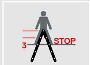
Beidseitig begehbare Stehleitern dürfen nur bis zur drittobersten Stufe/Sprosse bestiegen werden, damit ausreichender Halt möglich ist.
